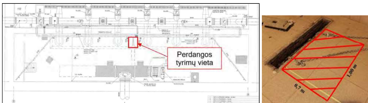
17 pav. Iš anksto suderinta gelžbetonio perdangos ekspertizės vieta grotų patalpoje
